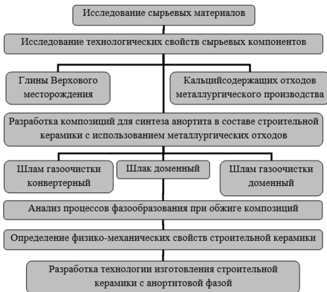
Рисунок 2.2 – Структурно-методологическая схема работы.
