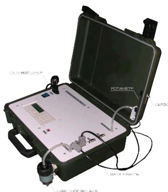
Рисунок 2.8 – Фотография газоанализатора ТЕСТ-1
