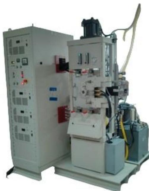
Рисунок 2.2 – Внешний вид установки для искрового плазменного спекания Advanced Technology SPS 10-4
