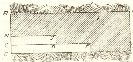
Черт. 1. Схема каменноугольной разработки в Домбровском бассейне. При выемке EFGC наблюдается сильное «стреляние» горной породы. При выемке пласта НИКЕ «стреляния» уже нет.
