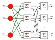
Рис. 2. Пример нейронной сети прямого распространения
