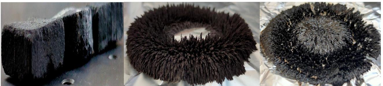
Рисунок 24. Материалы, изготовленные из феррита меди:
