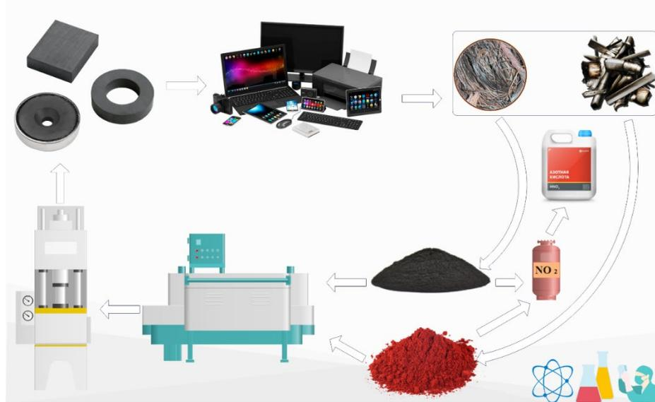
**Рисунок 20.** Схема получения феррита меди из металлических отходов
