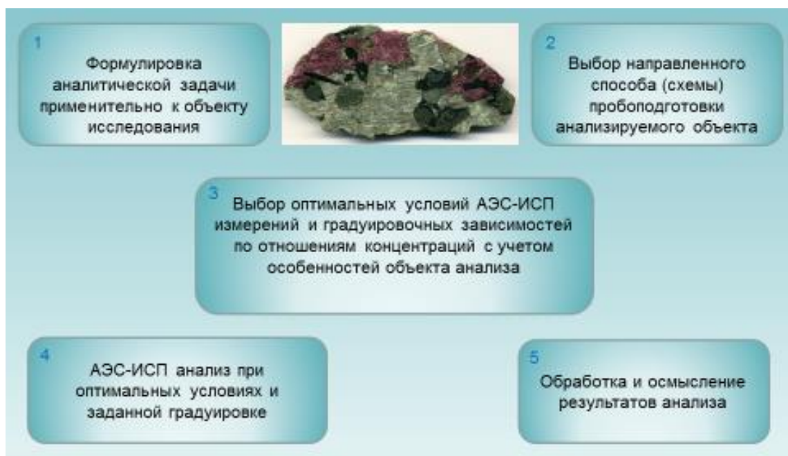
Рисунок 12 - Алгоритм АЭС-ИСП анализа геологических и технических материалов с градуировкой по отношениям концентраций
