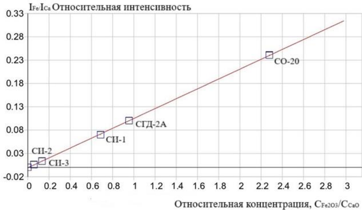
Рисунок 15 – Градуировочный график по отношениям концентраций для \text{Fe}_2\text{O}_3 ( y = 0,093x + 0,004 ; R = 0,9998 )
