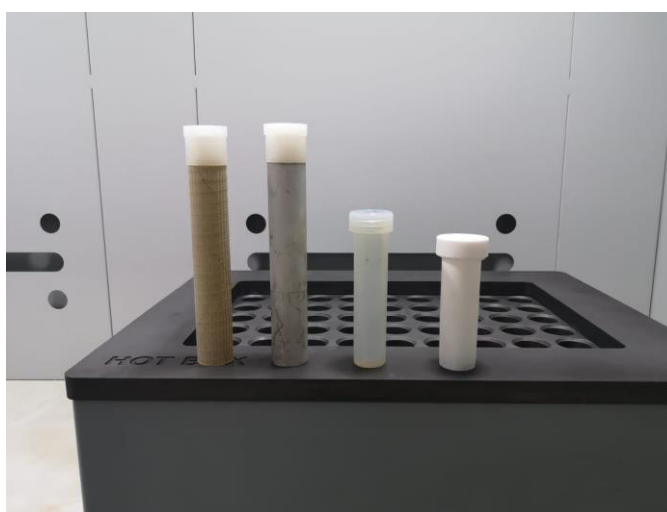
Рисунок 6 – Сосуды для разложения в системах с нижним резистивным нагревом: автоклавы в кевларовом и металлическом кожухах, пробирка из PFA и тефлоновая пробирка (слева направо)
