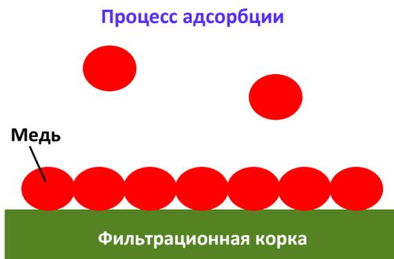
Рис. 1. Адсорбция меди на поверхности фильтрационной корки
