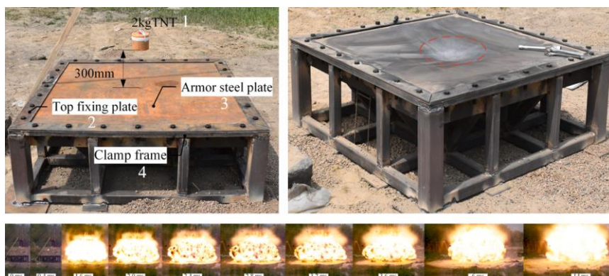
Рис. 5. Испытания стальной пластины на действие воздушного взрыва: 1 – заряд 2 кг тротила; 2 – верхняя крепежная пластина; 3 – бронева стальная пластина (экспериментальный образец); 4 – зажимная рама
