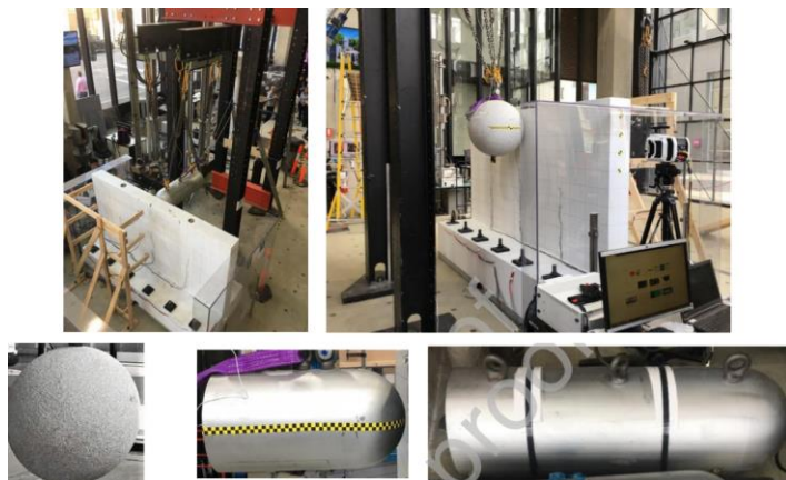
Рис. 7. Маятниковый копер и варианты ударяющего груза
