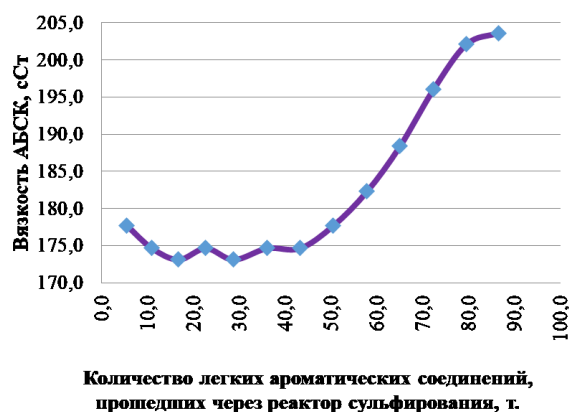
Рисунок 5 – Зависимость вязкости АБСК от количества легких ароматических соединений, прошедших через реактор сульфирования за межпромывочной период (расчет по модели)
