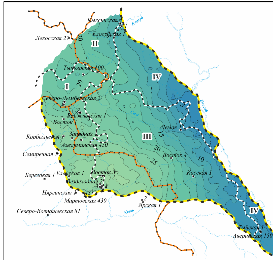
Рисунок 11 – Распределение пластовых давлений в кровле палеозоя. Условные см. Рисунок 10
