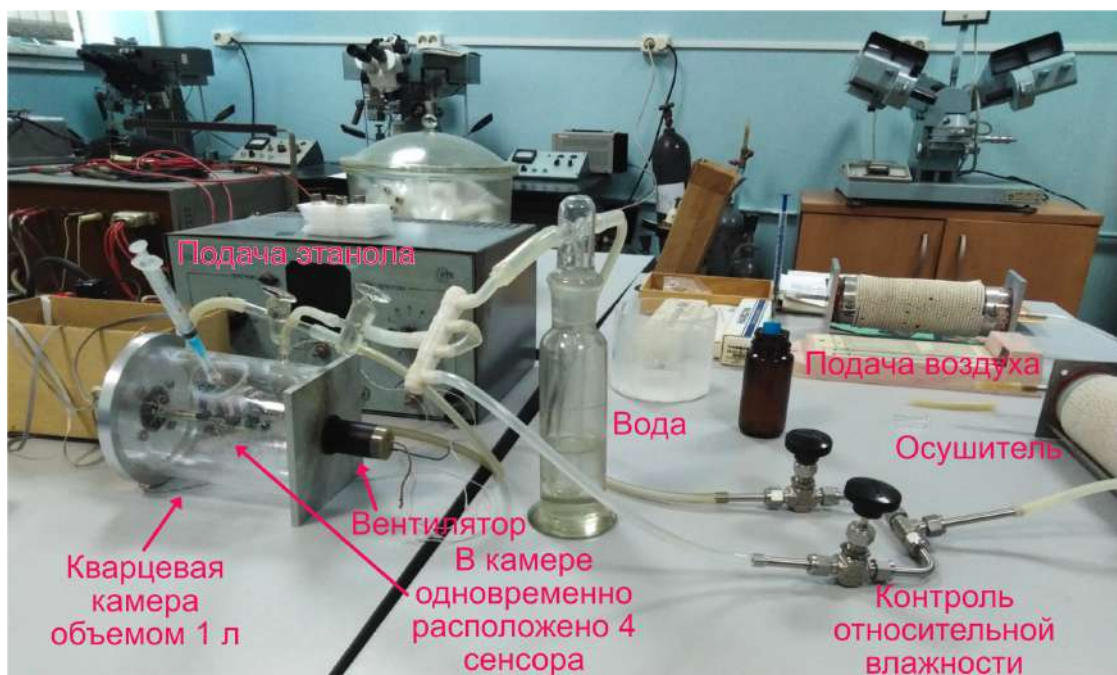
Рисунок 23 — Изображение установки для детектирования паров воды и спирта.
