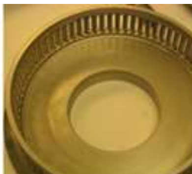
Рис. 2. Статор диспергатора Silverson
