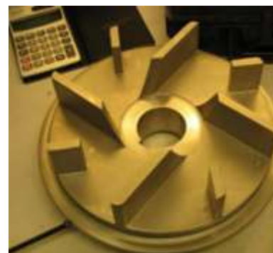
Рис. 3. Ротор диспергатора Silverson
