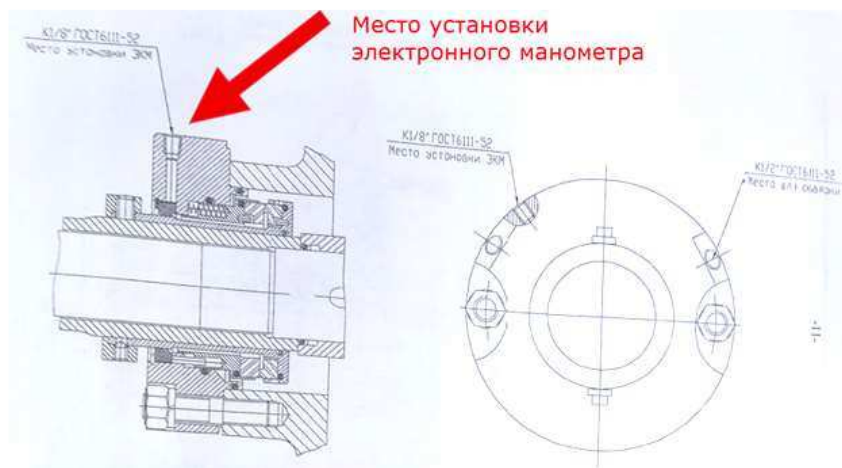
Рис. 4. Место установки электронно-контактного манометра
