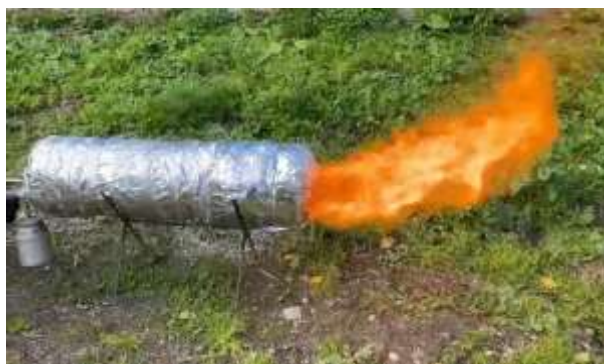
Рис. 1. Проведение полевых испытаний, фото горения суспензионного топлива
