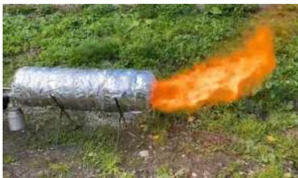
*Рис. 1. Проведение полевых испытаний, фото горения суспензионного топлива*
