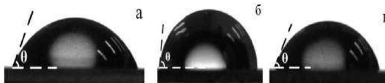
Рисунок 3. Форма капли и контактный угол для Ti (а), Ti-ON (б), КФ (в)
