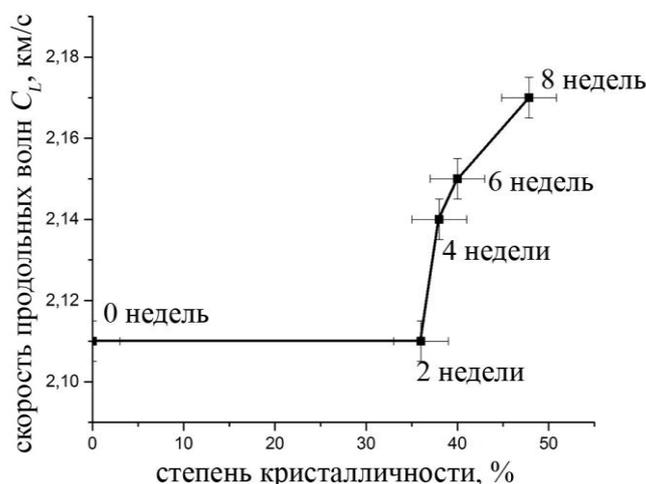
Рисунок 9 — График зависимости скорости продольных звуковых волн от кристалличности образца PLCL в течение 8 недель гидротермической выдержки [9]
