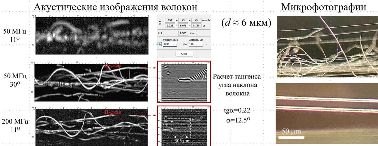
Рисунок 6 — Результаты ультразвуковой визуализации полимерных волокон диаметром 6 мкм с применением акустических линз с разной частотой (50 МГц и 200 МГц), и с разной угловой апертурой (11° и 30°)
