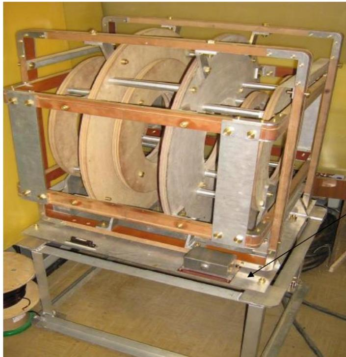
Рисунок 1.2 – Мера магнитной индукции БММИ
