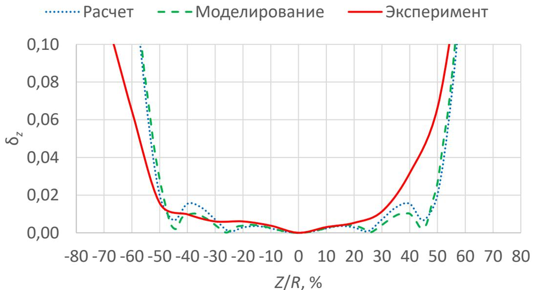
Рисунок 4.18 – Неоднородность магнитного поля десятикатушечной системы №1 вдоль оси  $Z$ , измеренная в центре системы
