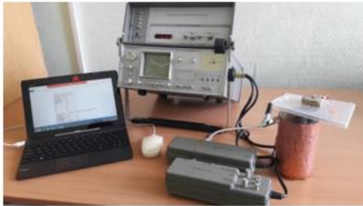
Рисунок 2.17 – Экспериментальная установка для измерения электрических характеристик электродной системы
