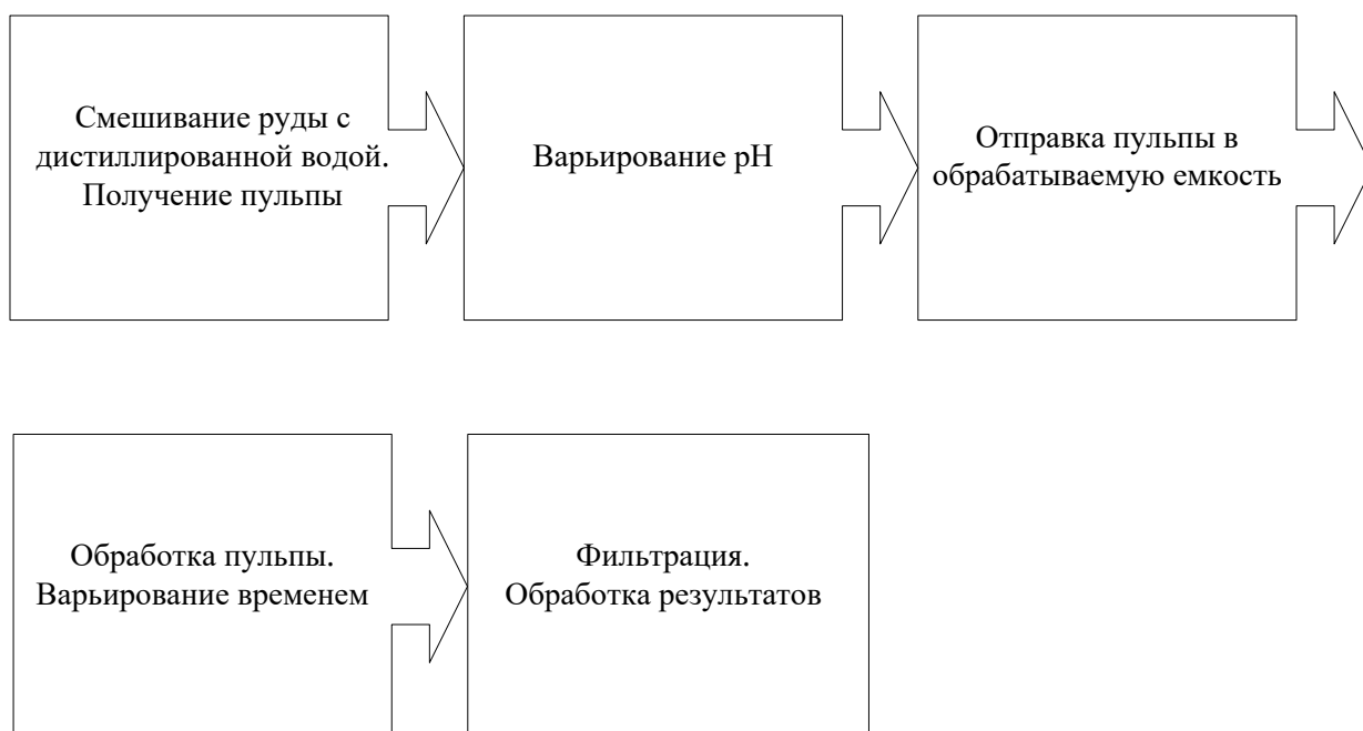
Рисунок 4.6 – Алгоритм работы установки
