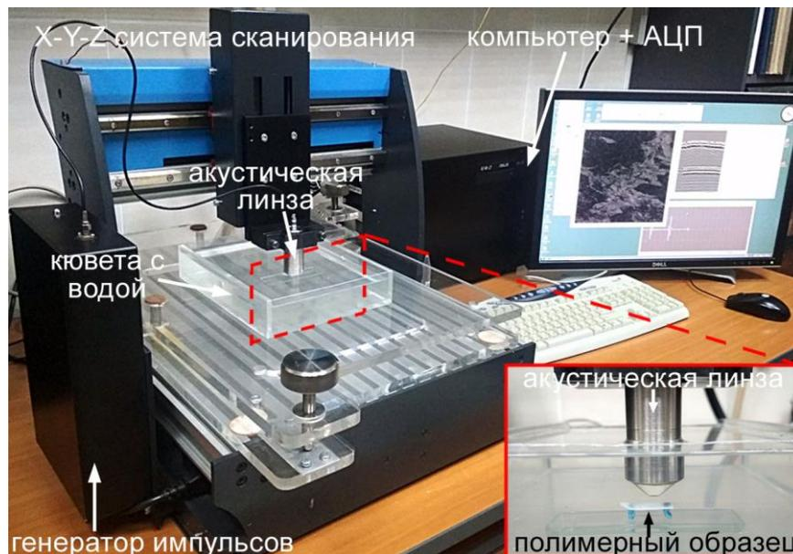
Рисунок 5.1. - Акустический микроскоп СИАМ-2011, применяемый для исследования полимеров. [A10]
