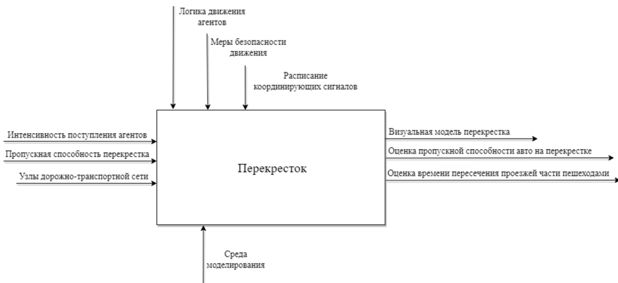
Рис. 2. Модель чёрного ящика перекрёстка как объекта моделирования
