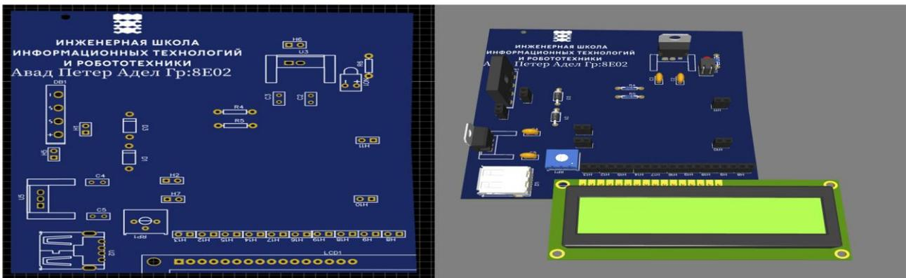
Рис. 8. Проектирование печатной платы PCB
