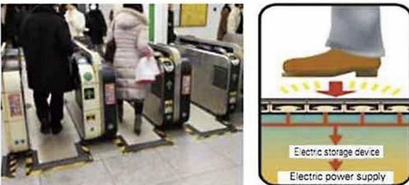
**Рис. 2.** Вид и местоположение платформы для генерации электроэнергии с помощью энергии шагов
