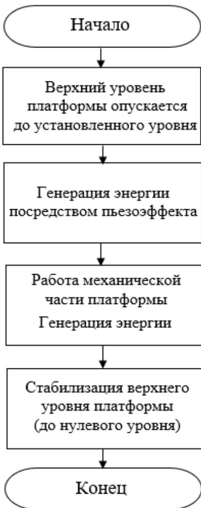
**Рис. 4.** Алгоритм работы платформы
