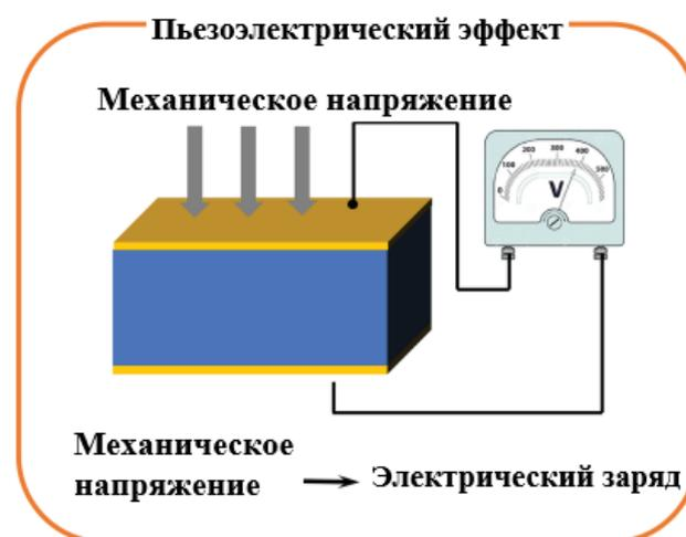
Рис. 6. Схема работы пьезоэлектрического эффекта
