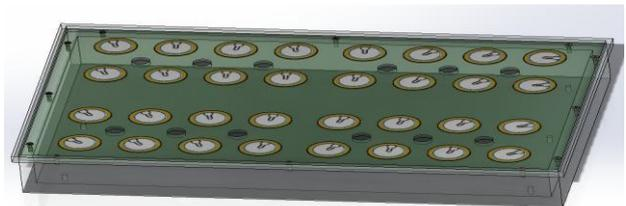
**Рис. 12.** 3D-модель пьезоэлектрической платы
