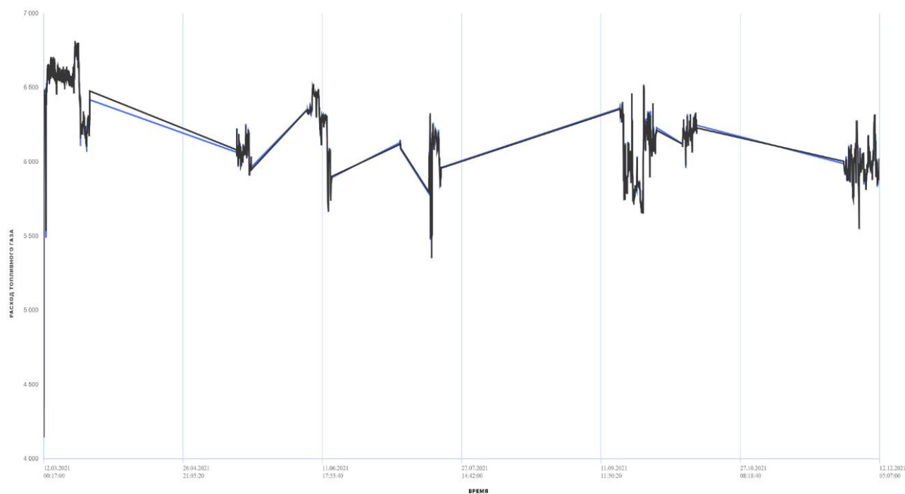
Рис. 4. Модель компрессорной установки: черный – исходные данные; синий – показания модели Fig. 4. Compressor unit model: black – initial data; blue – model readings
