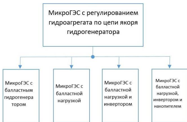
Рис. 2. Классификация систем генерирования и стабилизации напряжения микро-ГЭС по цепи якоря гидрогенератора
