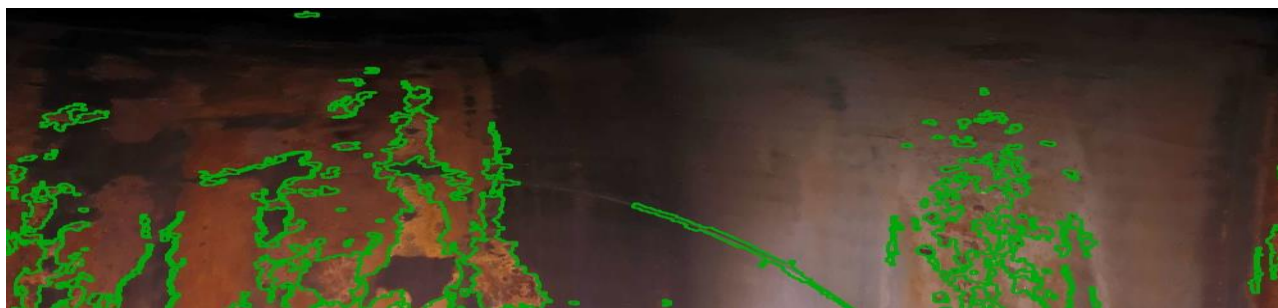
Рис. 3. Выделенные моделью U-Net области с дефектами Fig. 3. Areas with defects identified by the U-Net model
