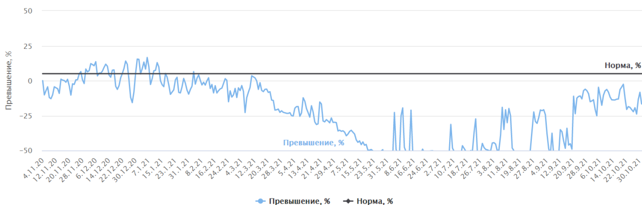
Рис. 3. График превышения температур теплоносителя обратного трубопровода рассматриваемой системы здания Fig. 3. Graph of excess temperatures of the coolant in the return pipeline of the building system under consideration
