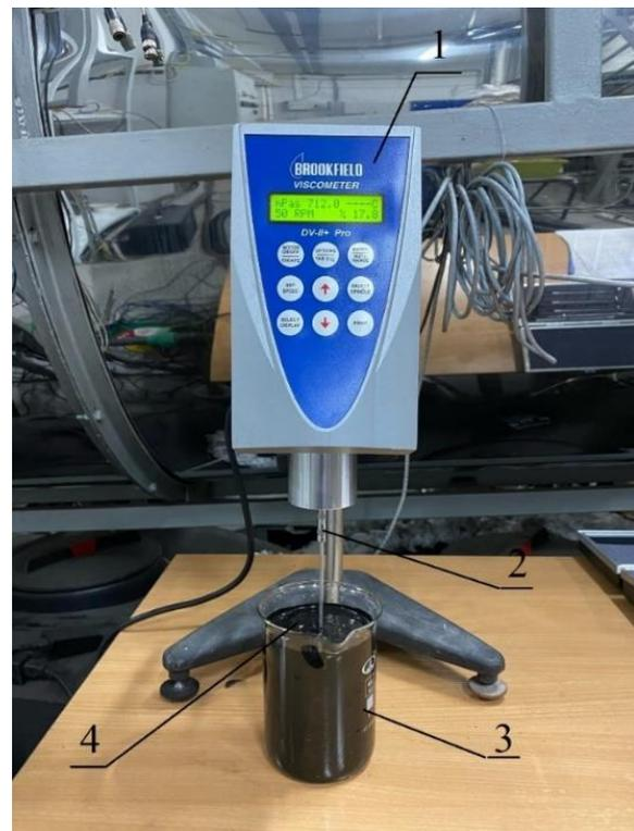
**Рис. 1.** Экспериментальная установка по измерению динамической вязкости ВУС (1 – ротационный вискозиметр; 2 – шпindel; 3 – цилиндрический стеклянный сосуд с исследуемой суспензией; 4 – Био-ВУС)
