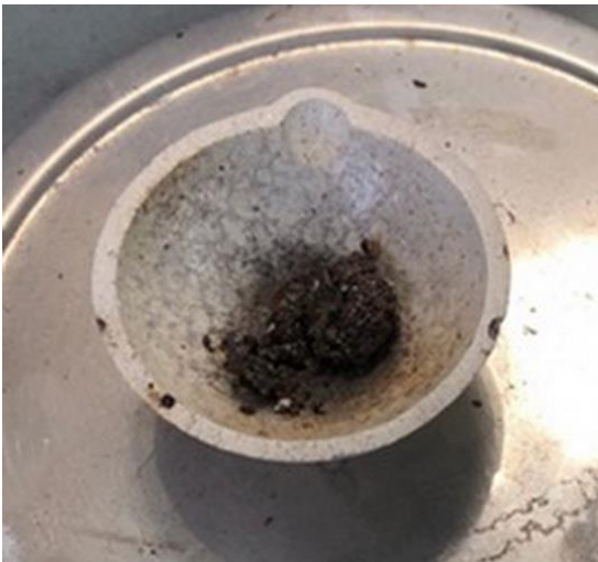
Рис. 1. Биоуголь, полученный при обработке куриного помета СВЧ-плазмой в течение 4 минут Fig. 1. Biochar obtained by processing chicken manure with microwave plasma for 4 minutes
