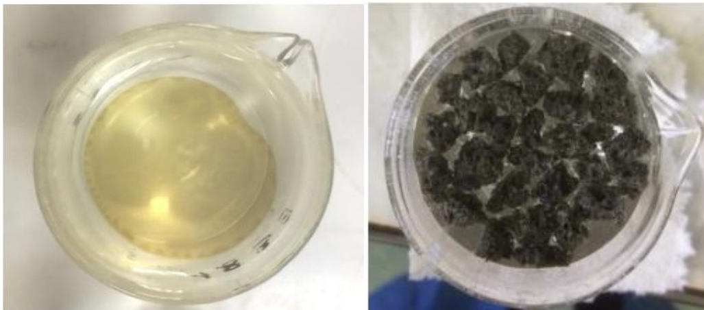
Рис. 2. Поглощение нефтяной пленки фосфатным сорбентом [32]
