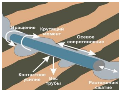
Рис. 13. Определяющие силы, действующие на бурильную трубу на преимущественно наклонном участке скважины
