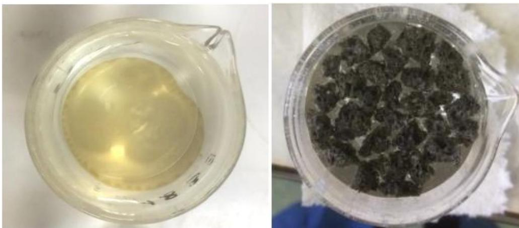
**Рис. 2.** Поглощение нефтяной пленки фосфатным сорбентом [32]
