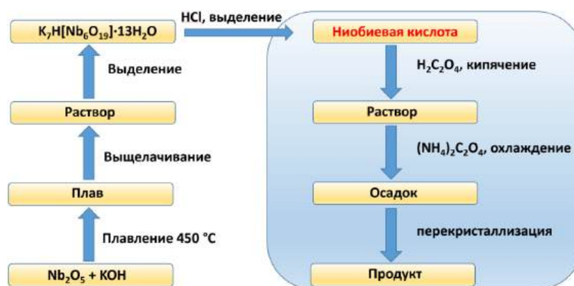
Схема 1. Семистадийный синтез (\text{NH}_4)[\text{NbO}(\text{C}_2\text{O}_4)_2(\text{H}_2\text{O})_2]
