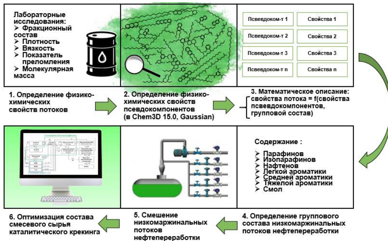
Рис. 1. Блок-схема алгоритма расчетов по оптимизации состава смеси сырьев каталитического крекинга
