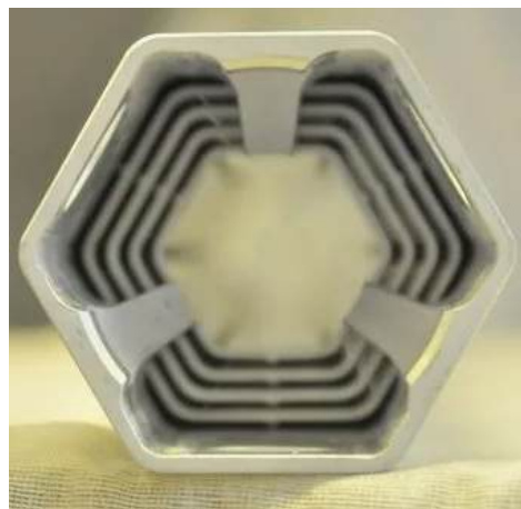
Рис. 1. «Вид хвостовика с твэлами ТВС»
