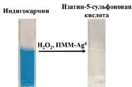
Рис. 1. Окисление индигокармина пероксидом водорода в присутствии ПММ-Ag 0
