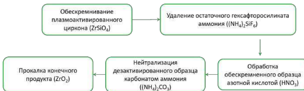
Рис. 1. Схема переработки цирконового концентрата
