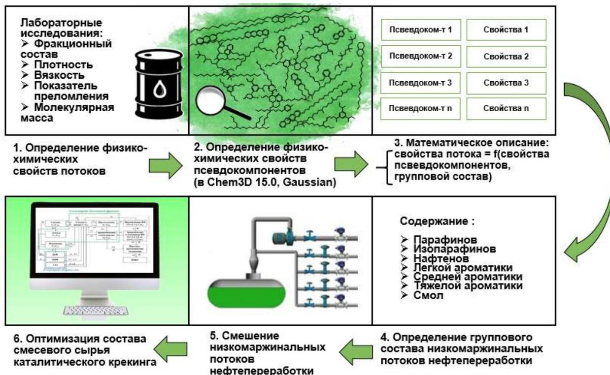
Рис. 1. Блок-схема алгоритма расчетов по оптимизации состава смесового сырья каталитического крекинга
