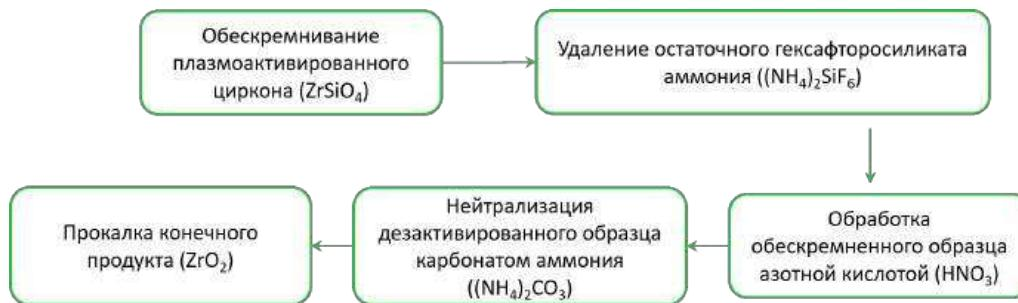
Рис. 1. Схема переработки цирконового концентратра
