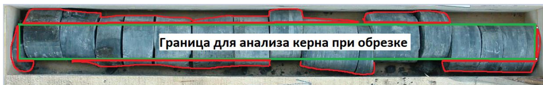
Рис. 5. Части керна, которые не учитываются при обрезке Fig. 5. Parts of the core that are not taken into account when trimming
