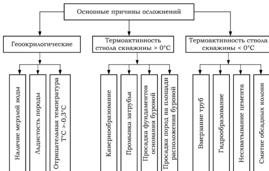
Рис. 2. Схема основных причин осложнений при бурении скважин в ММП
