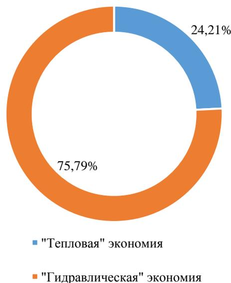
**Рис. 5.** Экономический вклад тепловой и гидравлической составляющей в снижение затрат на перекачку
