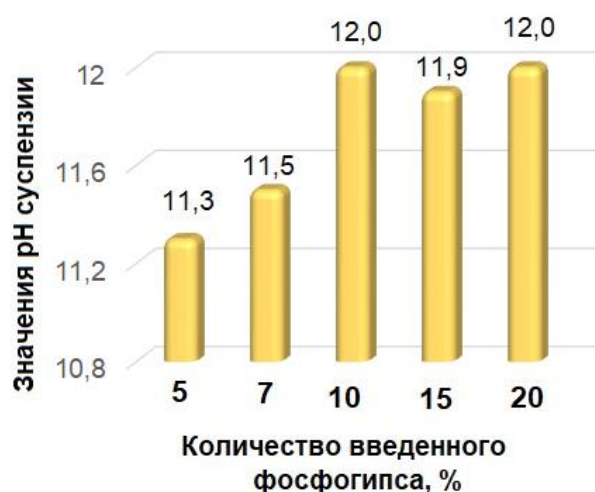
Рис. 4. Значения pH суспензии фосфогипса с различным содержанием реагента
