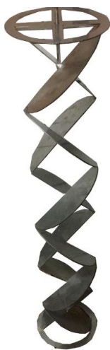
Рис. 3. Устройства для преобразования расслоенного потока в дисперсный [23, 24]
