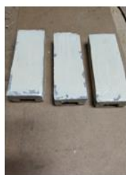
Рис. 10. Лабораторные образцы ангидритовых швеллеров размером 240×60×30 мм
