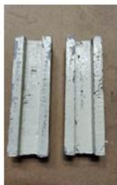
Рис. 10. Лабораторные образцы ангидритовых швеллеров размером 240×60×30 мм
