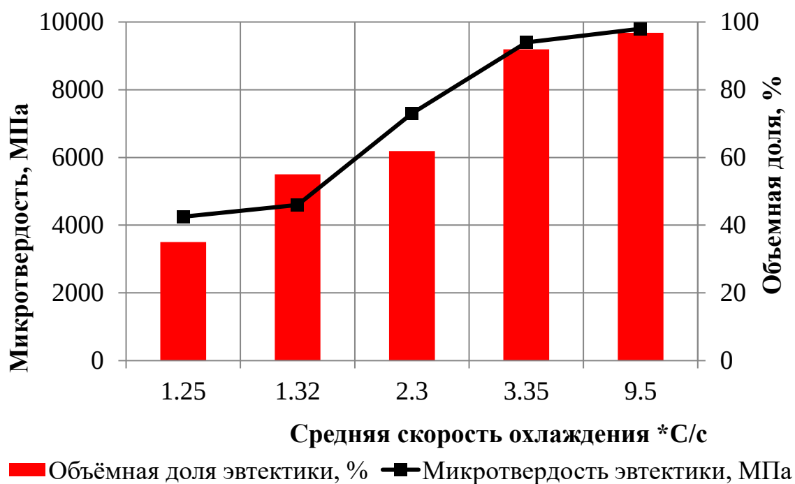
Рисунок 49 – Влияние режимов наплавки на долю эвтектики и её микротвёрдость
