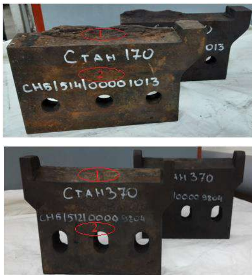
Рисунок 130 – Фотографии изношенных ножей станов 170 и 370 ПАО
