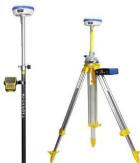
Рис. 1. ГНСС- приёмник
