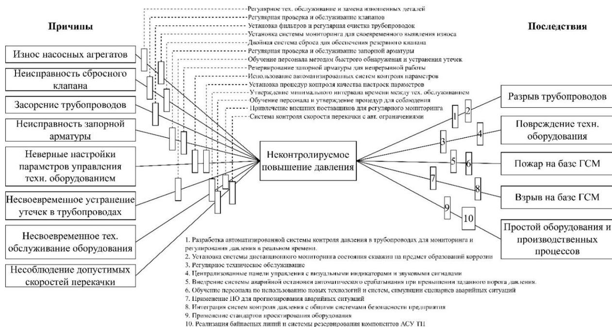
Рис. 3. Диаграмма «галстук-бабочка» для события неконтролируемого повышения давления при эксплуатации системы перекачки нефтепродуктов на базе ГСМ
