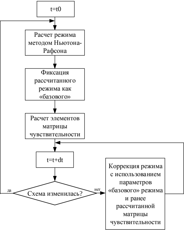
Рис. 1. Блок-схема алгоритма определения параметров режима работы распределительной электрической сети Fig. 1. Block diagram of the algorithm for determining the operating mode parameters of the distribution electrical network
