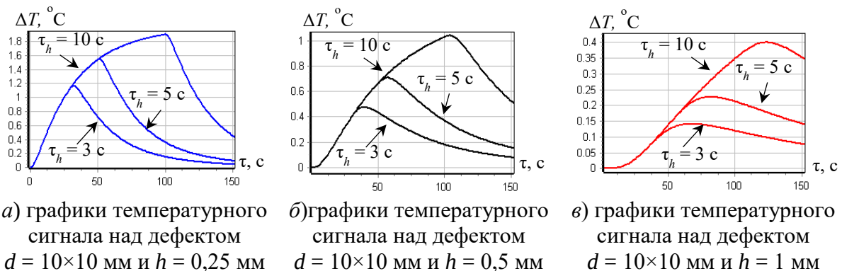
Рисунок 1 – Результаты моделирования ТНК пластины из углепластика толщиной 6 мм при нагреве импульсами длительностью 3, 5 и 10 секунд
