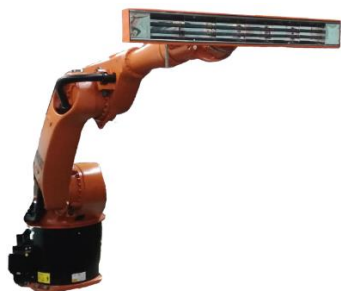
а) роботизированная установка ТНК крупногабаритных объектов
