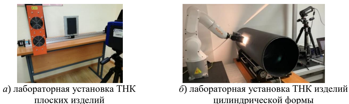
Рисунок 3 – Лабораторные установки для реализации ТНК способом тепловизионного сканирования
