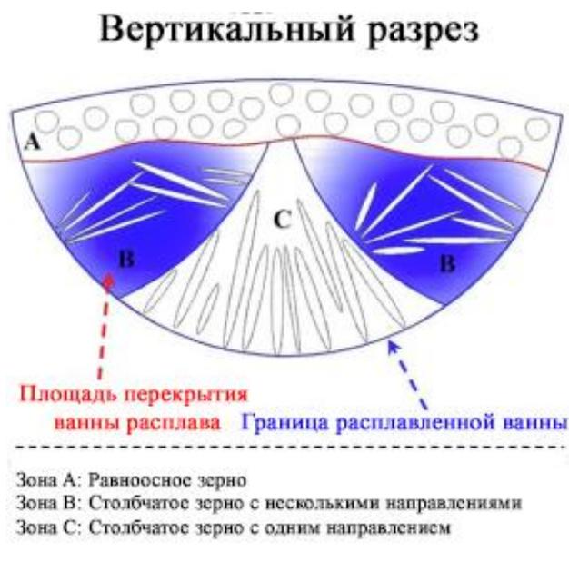
Рисунок 1.2 – Схематическое представление характеристик микроструктуры вдоль поперечного сечения одной ванны расплава во время процесса АП [51]
