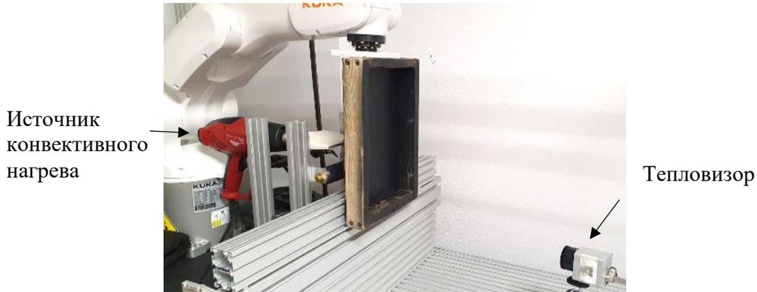
Рисунок 5.11 – Роботизированная установка для ТНК способом тепловизионного сканирования. Процесс оптимизации параметров нагрева конвективным источником
