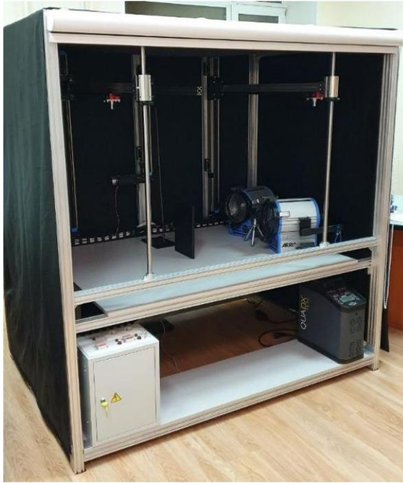
Рисунок 6.9 – Лабораторная установка ТНК с гибкой архитектурой для исследований ТФХ ПКМ и тепло- гидроизоляционных покрытий
