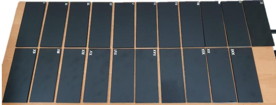
Рисунок 4.9 – Набор из контрольных образцов №1, №2 и №4 – №23, который был использован для практической апробации автоматизированного алгоритма дефектоскопии и дефектометрии, реализованный на базе ИНС (адаптировано из [8])
