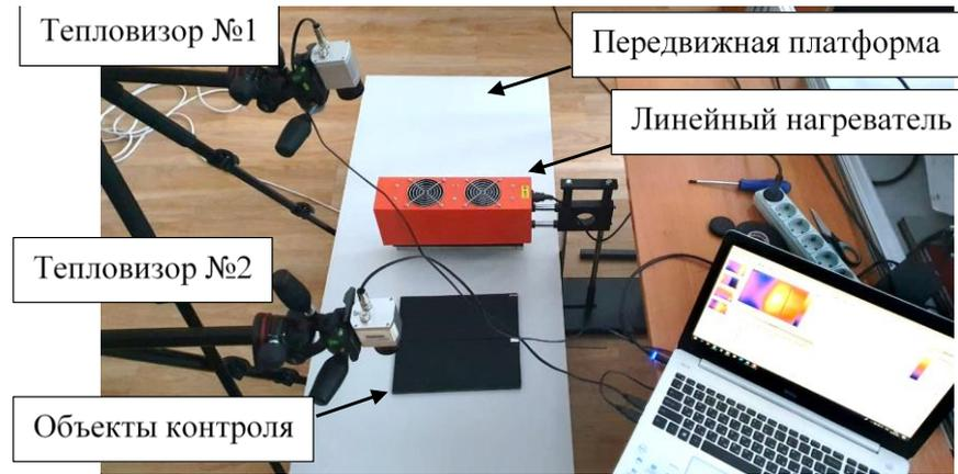
Рисунок 3.14 – Экспериментальная установка ТНК способом тепловизионного сканирования с использованием двух тепловизоров
