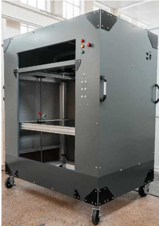
Рисунок 6.12 – Стационарная установка термоакустического контроля дефектов ПКМ
