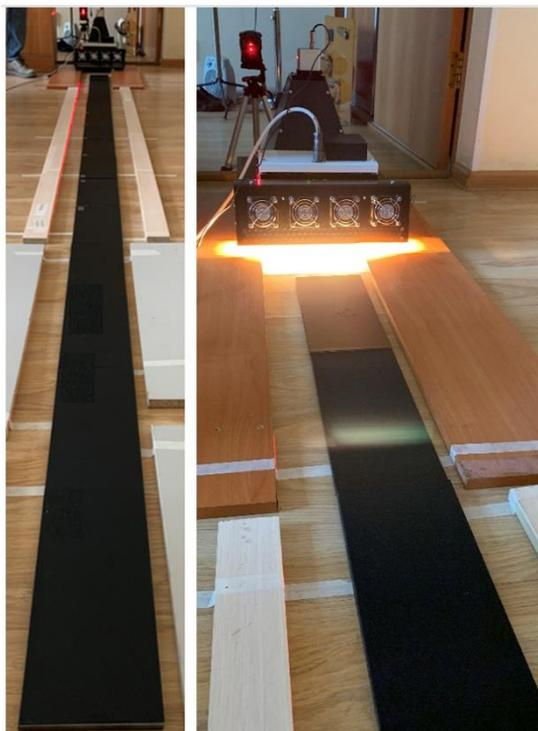
Рисунок 6.5 – Лабораторные испытания самодвижущегося теплового дефектоскопа при ТНК набора контрольных образцов способом тепловизионного сканирования
