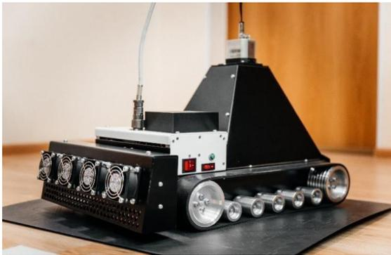
а) вид самодвижущегося теплового дефектоскопа в лабораторных условиях
