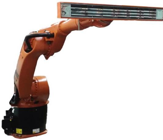
а) роботизированный манипулятор с линейным источником нагрева
