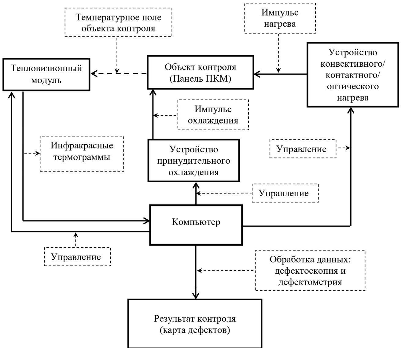
Рисунок В.3 – Структурная схема процедуры ТНК с применением линейного нагрева и принудительного охлаждения
