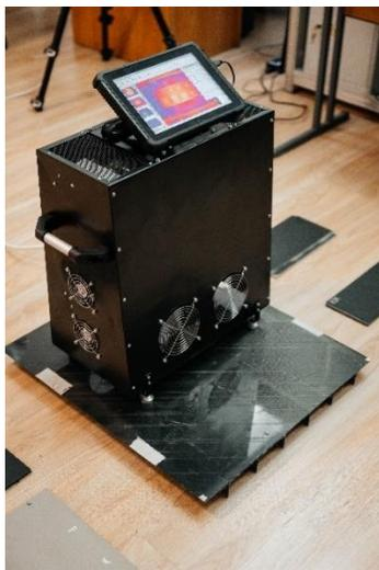
а) дефектоскоп в режиме определения ТФХ объекта контроля
