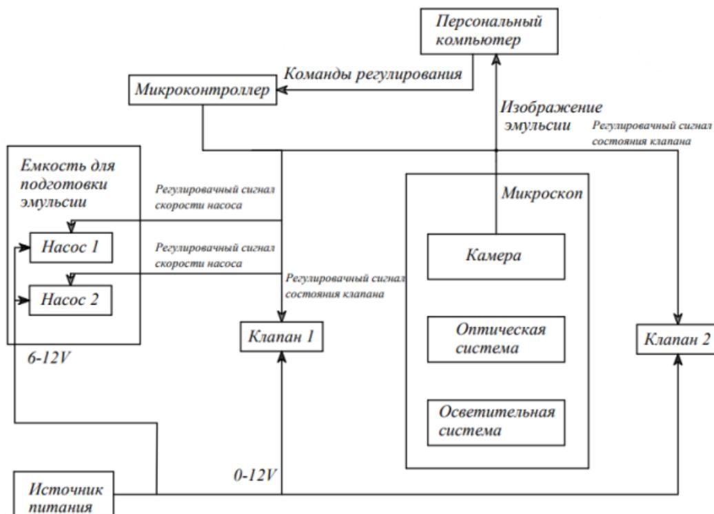
Рис. 1. Структурная схема стенда
