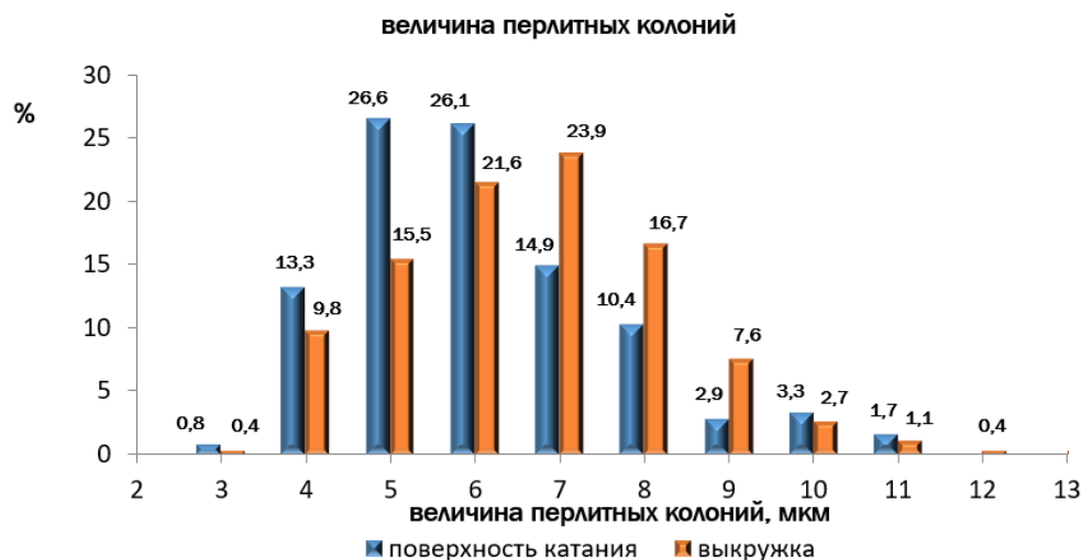
Рисунок 4.43 – Гистограмма распределения перлитных колоний по размерам
