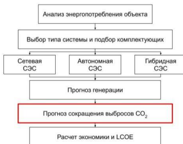
Рис. 2. Структура системы автоматизированного проектирования и прогнозирования выработки солнечной электростанции с учетом экологического аспекта (СЭС – солнечная электростанция)
