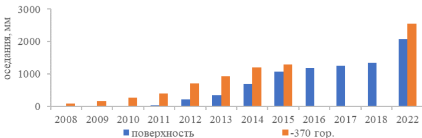
Рисунок 2 – Диаграмма распределения максимальных оседаний реперов наземной и подземной наблюдательных станций на 2008-2022 гг
